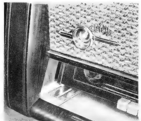
Bild 5. Chassis-Gleitbahnen am Boden eines Tonfunk-Empfängers
